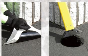
**科来福胶贴** 可用来粘帖标志杆，路面振动带，减速带，停车振动带，临时标志以及在沥青和水泥路面上粘帖使用的其他物件。胶贴是涂有改性沥青粘结剂的薄垫，即剥即贴，应用时需施加外部压力。
