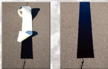
**抗裂贴** 是一种聚合物改性沥青材料，可以即剥即贴，是修补裂缝、路面补丁周围的细缝和水泥路面接缝的理想产品。抗裂贴的应用步骤很简单，首先要清理路面，保持粘贴区域的清洁与干燥，然后打开抗裂贴粘帖到裂缝上，将边缘加热压实以延长粘帖的时间。合理的使用抗裂贴能有效防止因水份渗透而造成的路面损坏，它可以在很宽泛的气候条件下使用。
